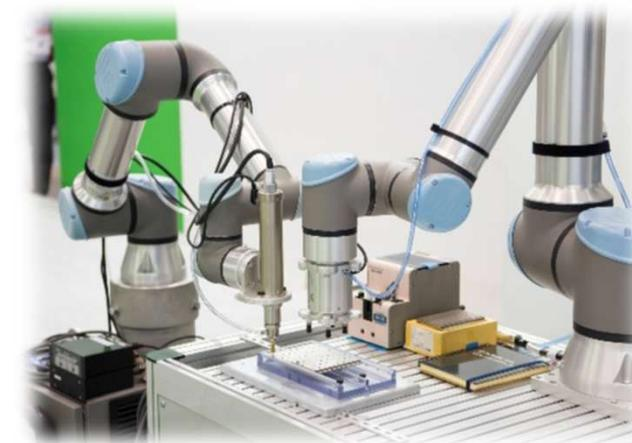
作業に合わせて、大小多彩なラインナップ。掴む/吸う/挟む等、シーンに合わせてハンド（手指）部分のオプションを用意しております。
