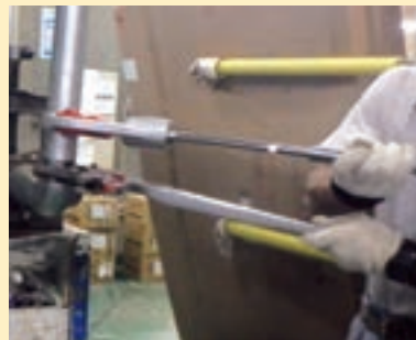
トルクレンチを使った作業現場
